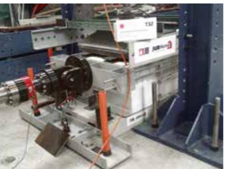
Test strižnega obnašanja pri ciklični horizontalni obremenitvi - simulacija potresa
