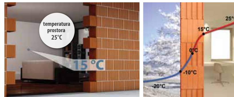
PROSTOR BEZ UGRAĐENE TOPLINSKE IZOLACIJE
