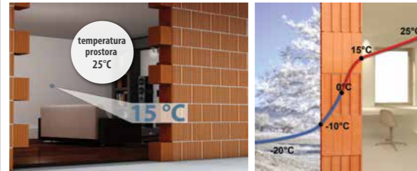
PROSTOR BEZ UGRAĐENE TOPLINSKE IZOLACIJE
