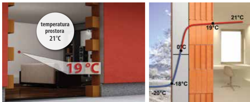
PROSTOR SA UGRAĐENOM TOPLINSKOM IZOLACIJOM
