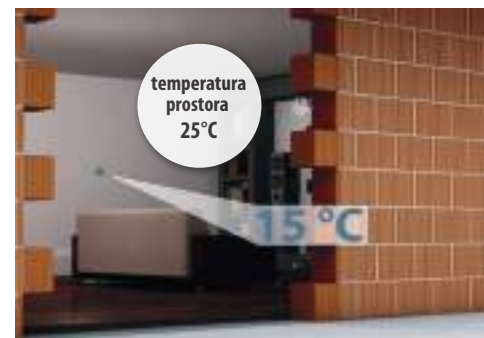
PROSTOR BEZ TOPLOTNE IZOLACIJE
