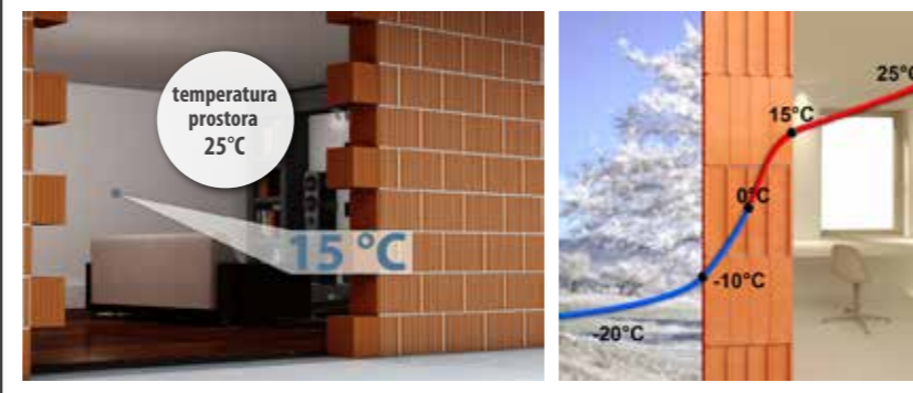
PROSTOR BREZ TOPLOTNE IZOLACIJE
