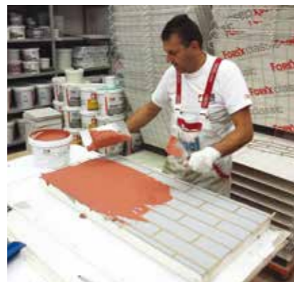
Slika 2: Priprema uzorka fasade JUBIZOL Brick
